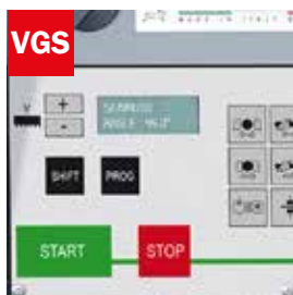
VGS VISUALIZZATORE GRADI ANGOLO DI TAGLIO Cutting angle display
